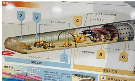
桂台トンネル内 (掘削前に、鋼管で地盤固定)
